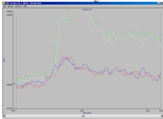
Obr. 3 pík reálného silně mineralizovaného vzorku s koncentrací 0.5 ug/l As
