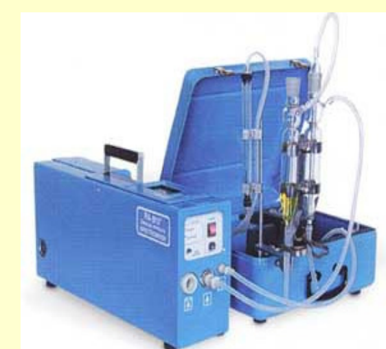
RA-915+ s RP-91 Stanovení Hg v kapalinách
