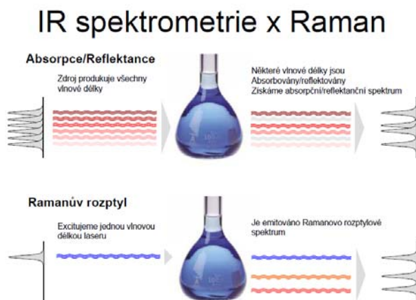
Obr. 1 Základní schéma infračervené a Ramanovy spektrometrie.
