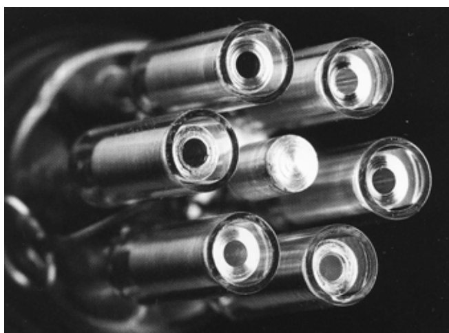
Obr. 2.3 Multikatodová lampa f. Photron (patent f. GBC)
