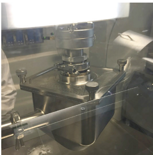
Obr. 4: Spektrometr MicroNIR PAT-W (VIAVI Solutions Inc.) instalovaný na laboratorní rotační mixer.
